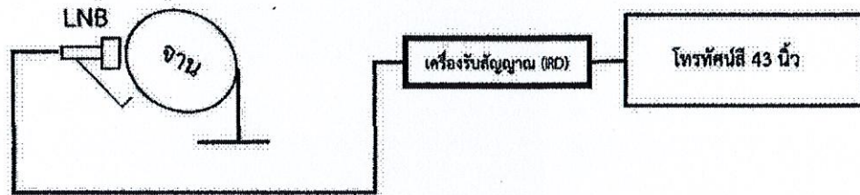
ภาพประกอบการติดตั้งจานดาวเทียม กลุ่มที่ 1
